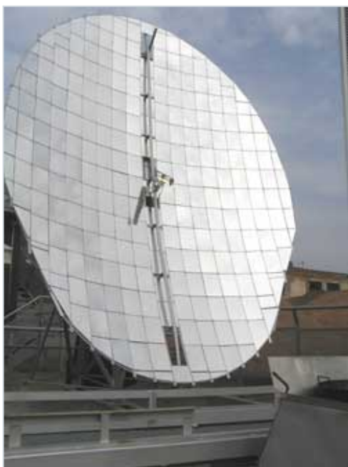
Reflector Solar Scheffler de 8m 2 con el foco secundario situado en el margen derecho de la foto.
